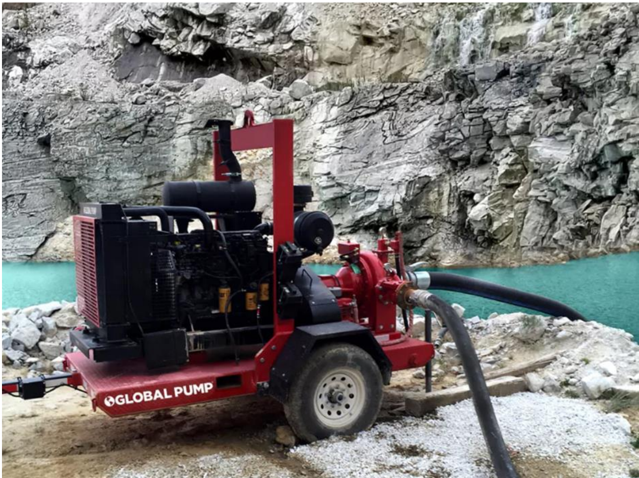
FIGURE 2.29 EXEMPLE D'UNE OPERATION D'ASSECHEMENT AU SEIN D'UNE MINE
