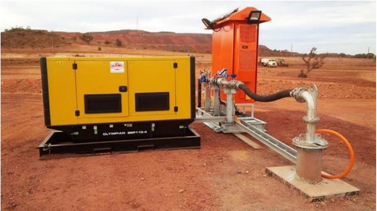
FIGURE 2.28 EXEMPLE DE PUIITS D'ASSECHEMENT DES FOSSES
