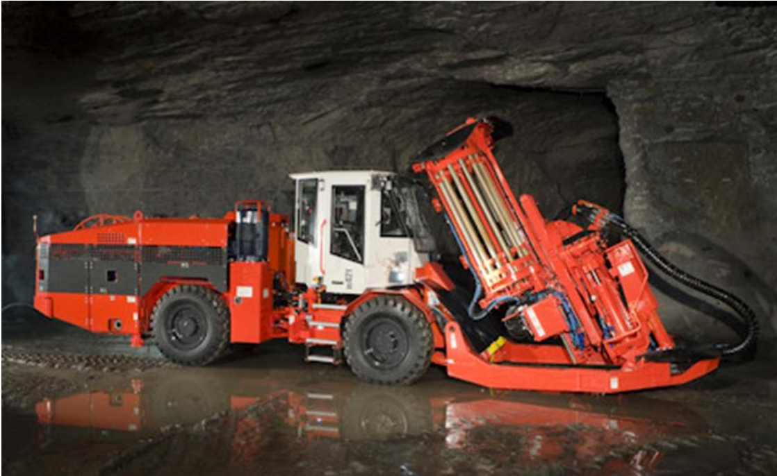
FIGURE 2.13 EXEMPLE D'ENGIN DE FORAGE LONGS TROUS
